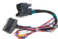
Кабель для подключения адаптера CAN шины к CAN шине автомобиля
